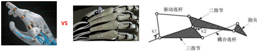
图：连杆传动灵巧手构造
